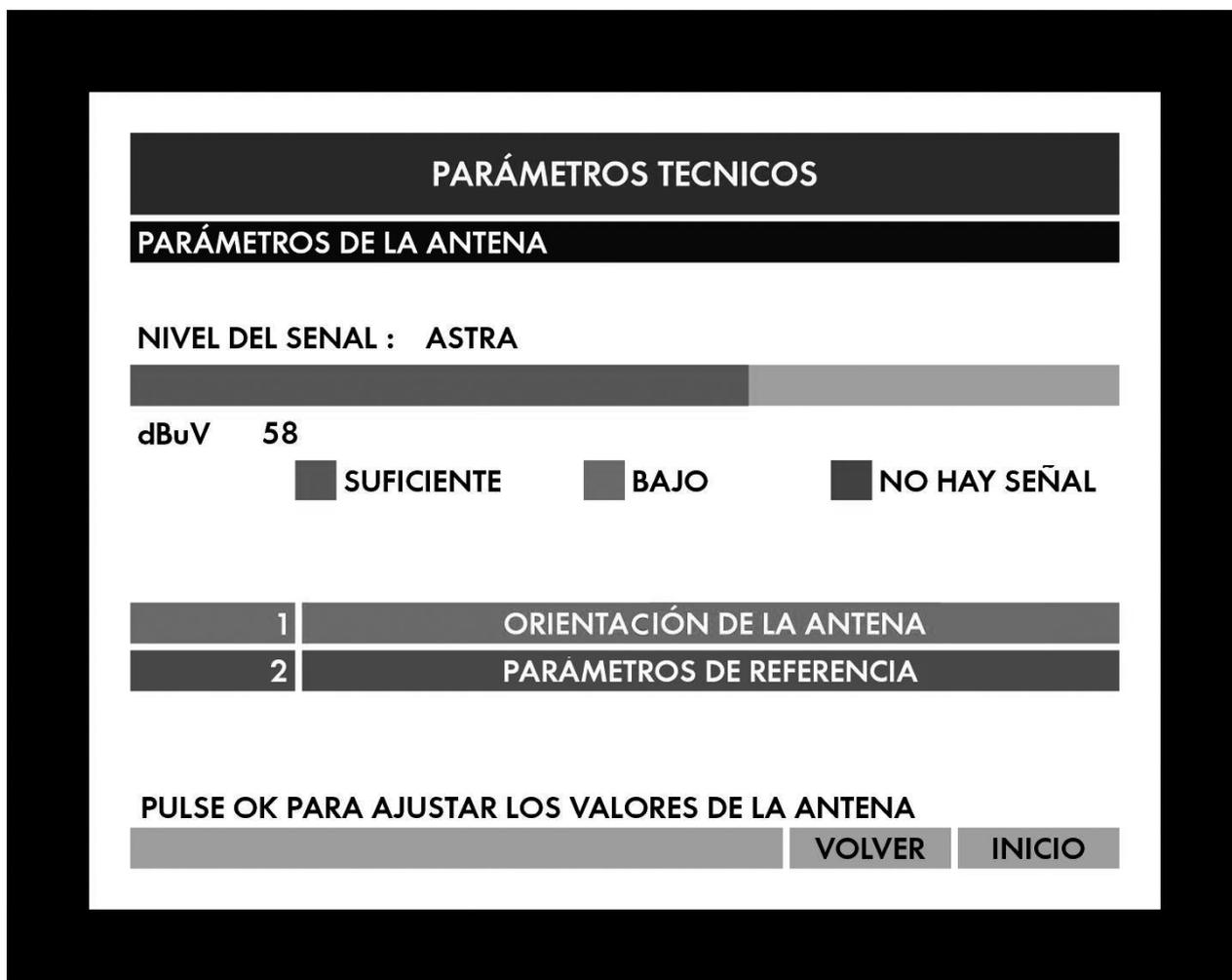
En la pantalla PARÁMETROS DE LA ANTENA se indica el nivel de señal de su antena parabólica y el satélite al que está orientada. El nivel de recepción de señal estará indicado con una barra de color verde si el nivel es suficiente, naranja si la señal es de baja calidad y rojo o sin barra de medida si no hay señal.
