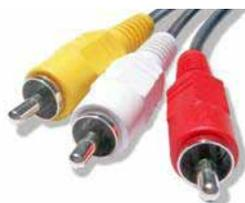
No permite el transporte de vídeo en alta definición, pero es muy común su utilización en la SDTV. La conexión analógica RCA está formada por un conector de color amarillo para el vídeo compuesto y por otros dos RCA, blanco y rojo, para el audio estéreo. Este tipo de conectores se sitúan normalmente en las televisiones en posición frontal, o en algún lugar de fácil acceso, para conectar de forma sencilla videocámaras o cámaras fotográficas digitales.
