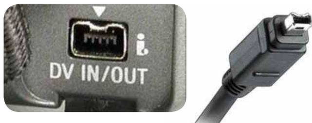
El interfaz Firewire es la conexión digital del formato de vídeo DV. Este conector proviene del ámbito informático y se utiliza para transferir el contenido de las cámaras de vídeo DV al PC. El Firewire no suele estar presente en los televisores.
