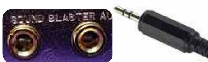
El conector Jack sólo permite transportar señal de audio en mono o en estéreo y es el método de conexión entre equipos de sonido más utilizado (micrófonos, auriculares, etc.). En las televisiones normalmente se usa como entrada de audio asociada al conector VGA o DVI para la conexión de PC.
