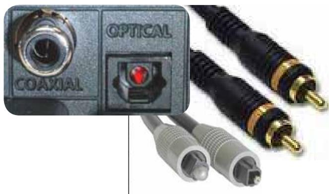
El S/PDIF es el acrónimo de Sony/Philips Digital Interface Format y permite transportar audio estéreo o multicanal comprimido. Existen dos tipos de conexión: la óptica o la coaxial.
